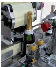
Notre technique de pose de face, bouteille à l'arrêt, assure une précision inégalée, insensible à la conicité du col de la bouteille.
